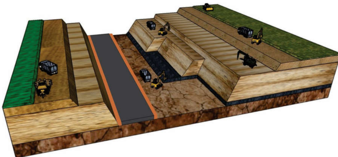
Figura 3 apresenta o esquema de lavra proposto para a Mina Santana Céu Aberto com utilização do método stripping mining .
